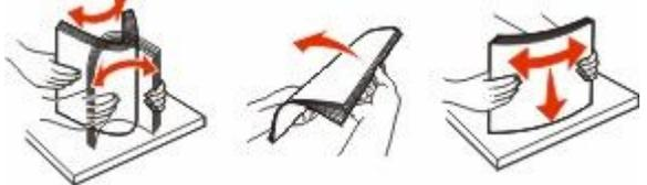
Biegen Sie das Papier vor dem Einlegen in das Fach in beide Richtungen, fächern Sie es auf, und gleichen Sie die Kanten dann auf einer ebenen Fläche an.
