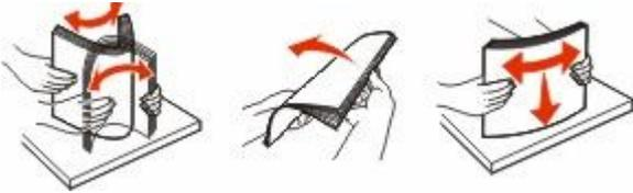
Biegen Sie das Papier vor dem Einlegen in das Fach in beide Richtungen, fächern Sie es auf, und gleichen Sie die Kanten dann auf einer ebenen Fläche an.
