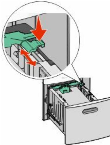
Drücken Sie auf die Entriegelung der Längenführung, schieben Sie die Führung in die gewünschte Position, und stellen Sie die Führung wieder fest.
