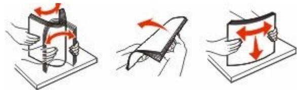
Biegen Sie den Papierstapel oder die Spezialdruckmedien vor dem Einlegen in das Fach in beide Richtungen, fächern Sie sie auf, und gleichen Sie die Kanten dann auf einer ebenen Fläche an.
