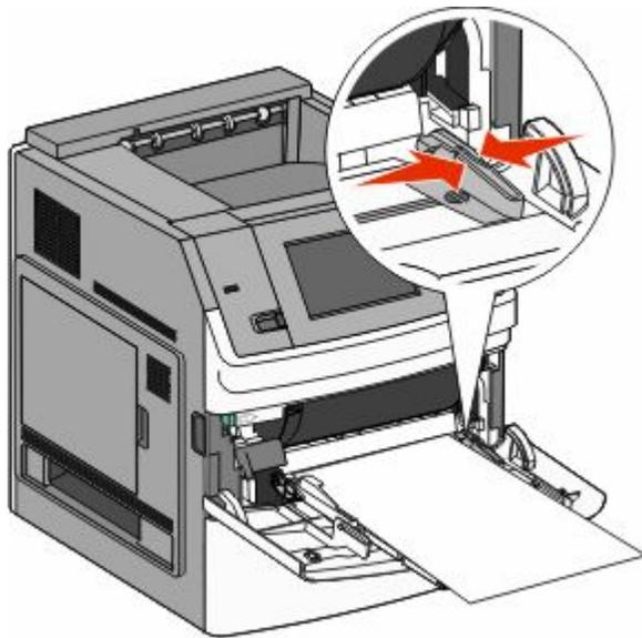
Schieben Sie das Papier so weit wie möglich in die Universalzuführung ein und passen Sie die Seitenführung so an, dass sie an der Kante des Papierstapels anliegt.
