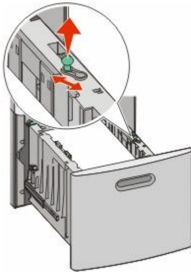
Heben Sie die Seitenführung an, und schieben Sie sie in die für das einzulegende Papier vorgesehene Position.
