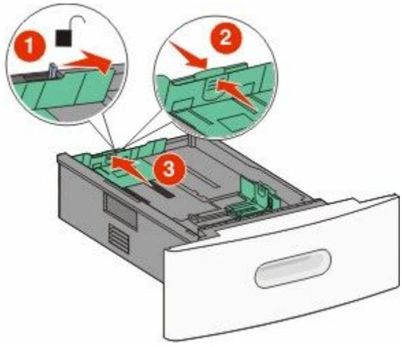
Drücken Sie die Längsführung zusammen und schieben Sie sie in die für das einzulegende Papier vorgesehene Position.
