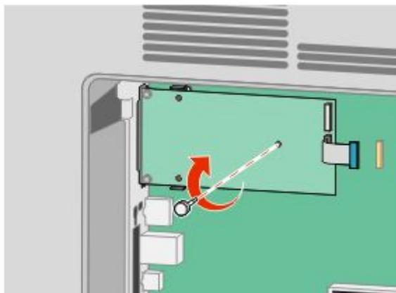
**10** Befestigen Sie die ISP-Halterung mit den beiden mitgelieferten Schrauben am Systemplattenrahmen.
