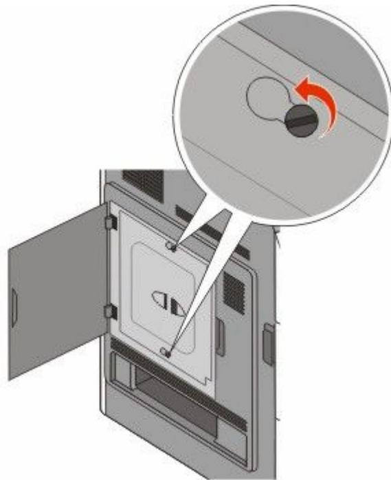
3 Entfernen Sie die Systemplatinenabdeckung.
