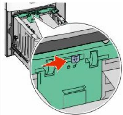
Lösen Sie die Längenführung.
